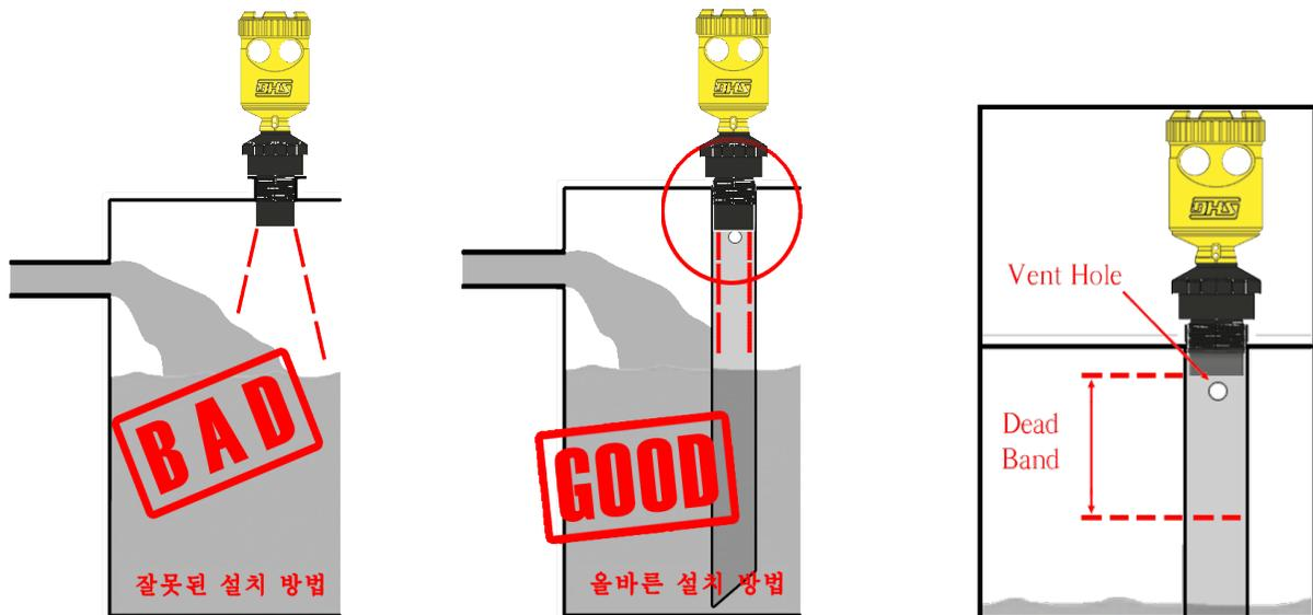
탱크 상부에 낙수가 있을 경우 센서 빔진행에 영향을 주지 않도록 하고, 낙차에 의한 너울이나 기포 로 인해 센서 오작동이 발생하지 않도록 해야 합니다.
